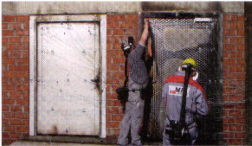
Zahlreiche Sensoren an den Türblättern und Zargen sorgen bei den Tests für exakte Messwerte, auch die Verformung der Brandschutztür wird während der Tests gemessen
