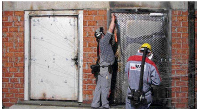
Noch während des Tests wird die Verformung der Brandschutztür gemessen.
