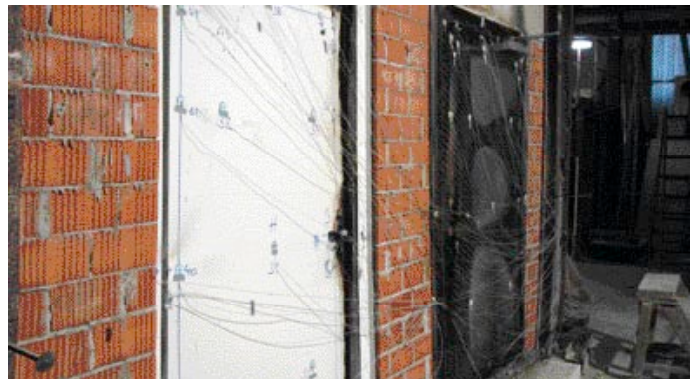
Zahlreiche Sensoren an den Türblättern und Zargen sorgen für exakte Messwerte.
