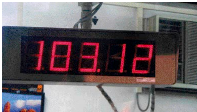
Nach 103 Minuten ist der T90-Test beendet. Die Cool it Brandschutztür hat erfolgreich bestanden.
